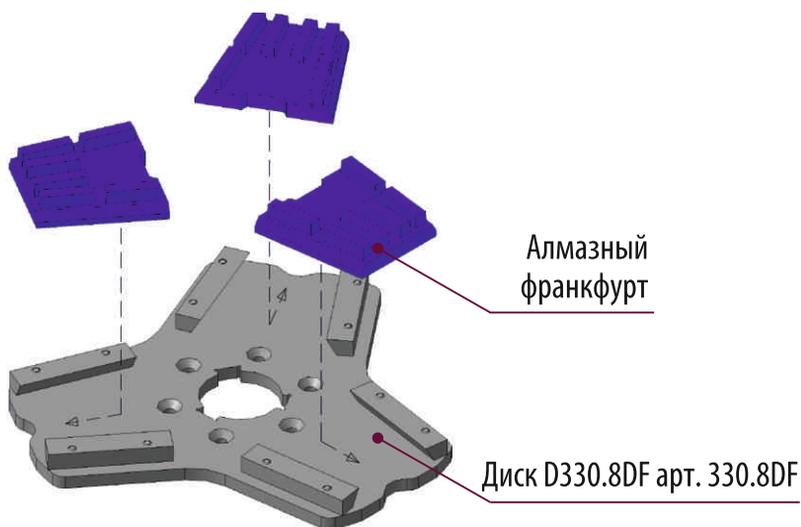
**Рис. 15 Установка алмазных франкфуртов**
