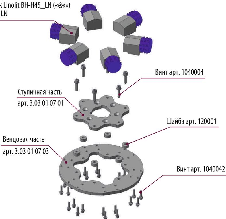
Рис. 10 Установка рабочих блоков
